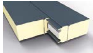
Стандартний замок для стінової панелі GS insPIRe® S (для товщини 100, 120 мм)
