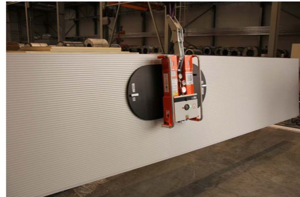
Zdjęcie nr 2. Urządzenie próżniowe z przyssawką centralną.
