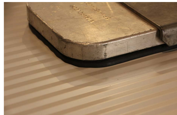
Zdjęcie nr 4. Niskoprofilowa przyssawka urządzenia próżniowego. Elastyczna uszczelka obwodowa przyssawki po wytworzeniu podciśnienia zapewnia podparcie na całej powierzchni styku przyssawki z płytą warstwową.
