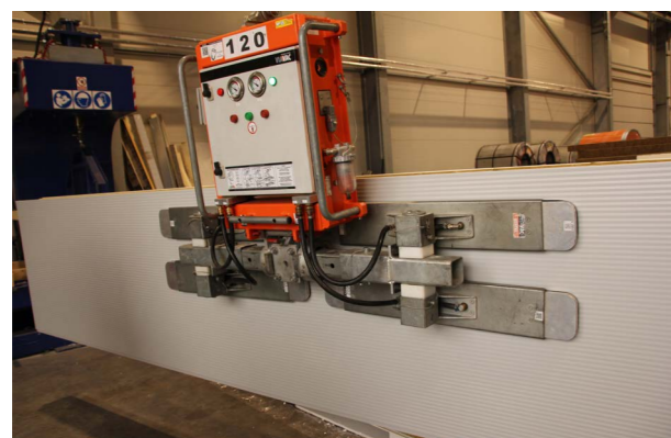
Zdjęcie nr 1. Wieloprzyssawkowe urządzenie próżniowe.
